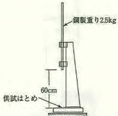
合成樹脂製はとめの衝撃試験の例
